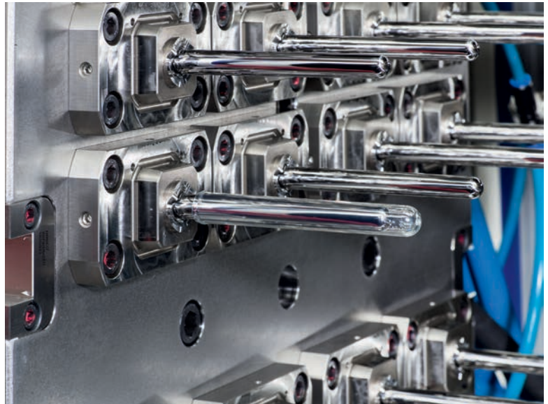
Aus Analysegründen muss die Oberfläche der Blutröhrchen absolut glatt und transparent sein, weshalb Kerne und Kavität eine Hochglanzpolitur aufweisen.
